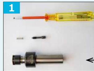
1 スクリューを適切なドライバ（平頭 1）で円筒から抜きます。乾燥した圧縮エアをあて汚れを吹き出します。粘度の低いオイルを10滴注します。
