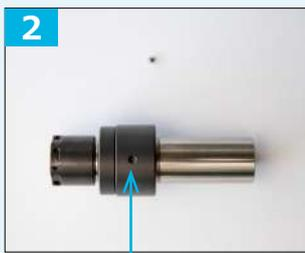
2 スクリューを一個戻します。粘度の低いオイルを10滴注します。
