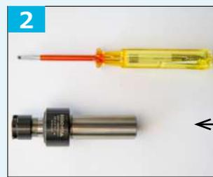
2 スクリューを戻します（スプリングも必ず戻してください）。円筒シャフトのスプリングの張りを調整します。
